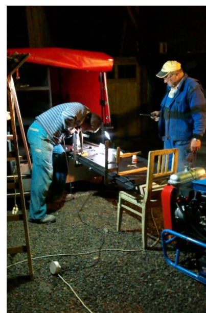
Výroba vestavby – montáž výsuvného pojezdu na agregáty a bedny.
